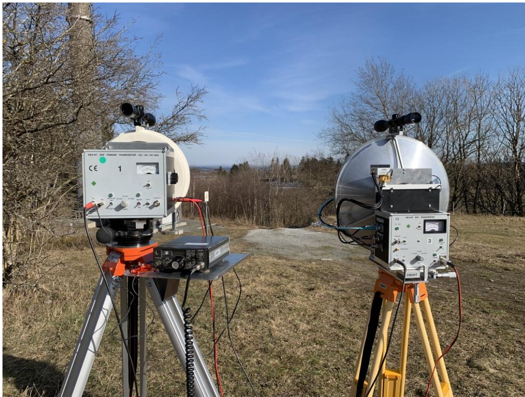
Links die Triband-Station 122/134/241 GHz bei DK5NJ (Schwedenwache JO50TI) und rechts die neue Triband-Station in der bis jetzt nur 241 GHz aufgebaut ist.
